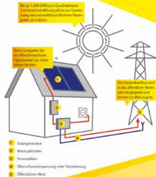
Das Prinzip ist im Grunde ganz einfach: Mit Hilfe von Solarmodulen, die aus vielen einzelnen Solarzellen bestehen, wird einfallendes Sonnenlicht absorbiert und direkt in elektrische Energie umgewandelt.
